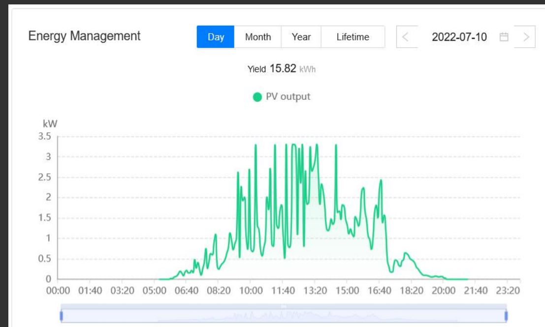
Wykres produkcji energii elektrycznej przez instalację fotowoltaiczną o mocy 3,115kWp w dniu 10.07.2022
