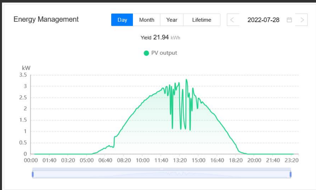
Wykres produkcji energii elektrycznej instalacji fotowoltaicznej o mocy 3,465kWp w dniu 28.07.2022
