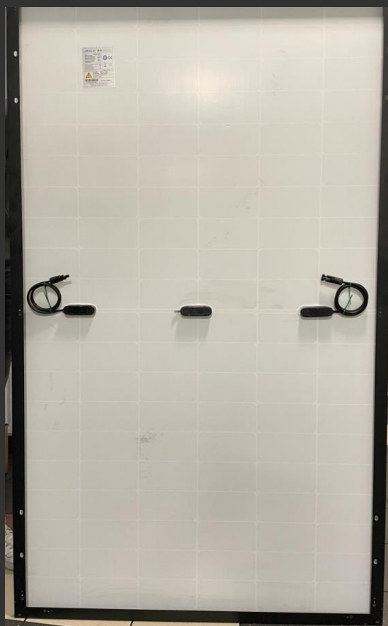
Zdjęcia modułu monofacjalnego z folią EVA z tyłu
